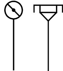
29 Присоединительное устройство к другим системам (испытательным, промывочным машинам, кондиционерам рабочей среды и т. п.)
